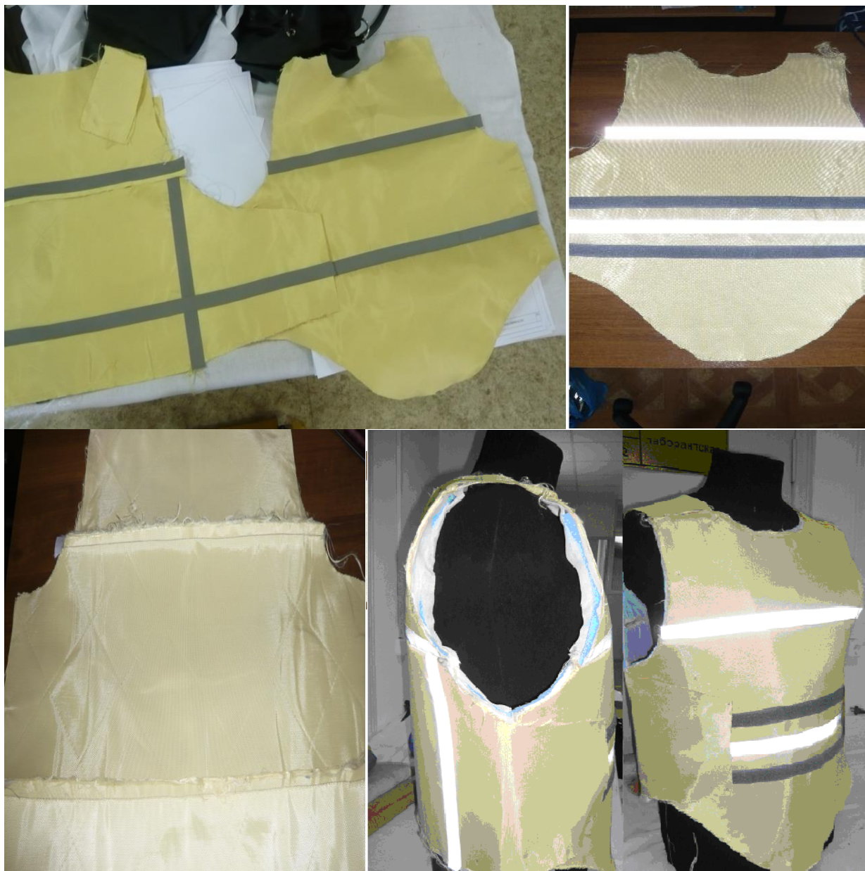
Рисунок 4.13 – Процесс сборки шумозащитного жилета
