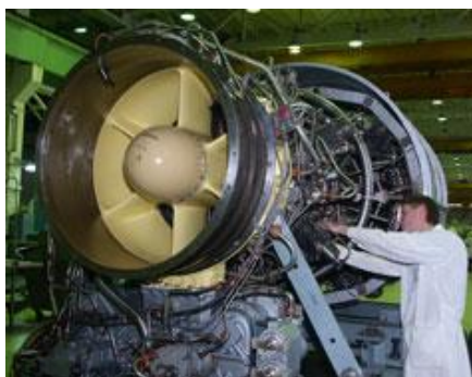
Рисунок 1.5 – Приводной авиадвигатель на газоперекачивающей установке
